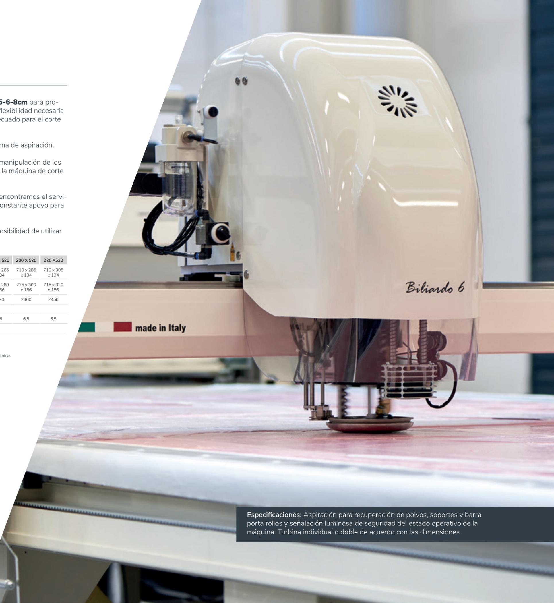
**Especificaciones:** Aspiración para recuperación de polvos, soportes y barra porta rollos y señalación luminosa de seguridad del estado operativo de la máquina. Turbina individual o doble de acuerdo con las dimensiones.
