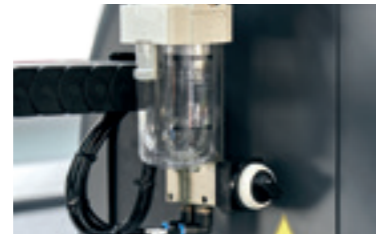
Sistema de enfriamiento o de lubricación de la cuchilla de acuerdo con los tejidos.
